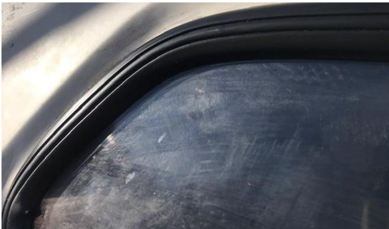
Den færdige gummiliste med låsekileliste monteret. (Foto: Mads Prang Roesen).
