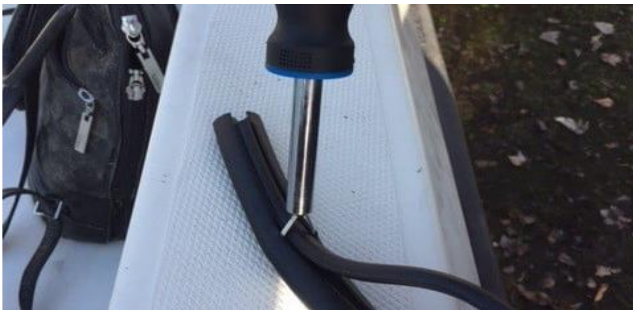
Sådan bruges låsekileværktøjet, men selvfølgelig først når gummilisten sidder på plads. (Foto: Mads Prang Roesen).
